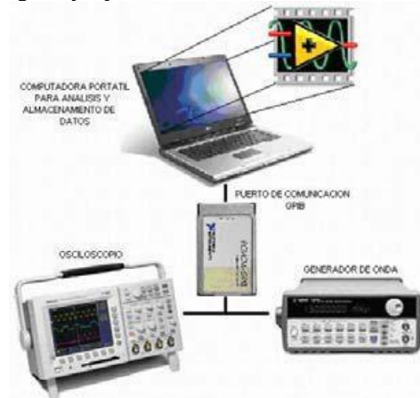
Fig. 3. Diagrama del sistema implementado usando la interfaz GPIB
