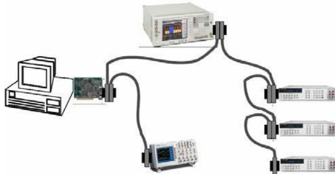
Fig. 2. Ejemplo de conexión de un sistema GPIB.
